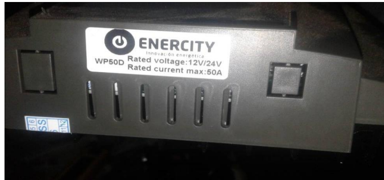
Figura 33-3: Regulador de voltaje rango de operación
