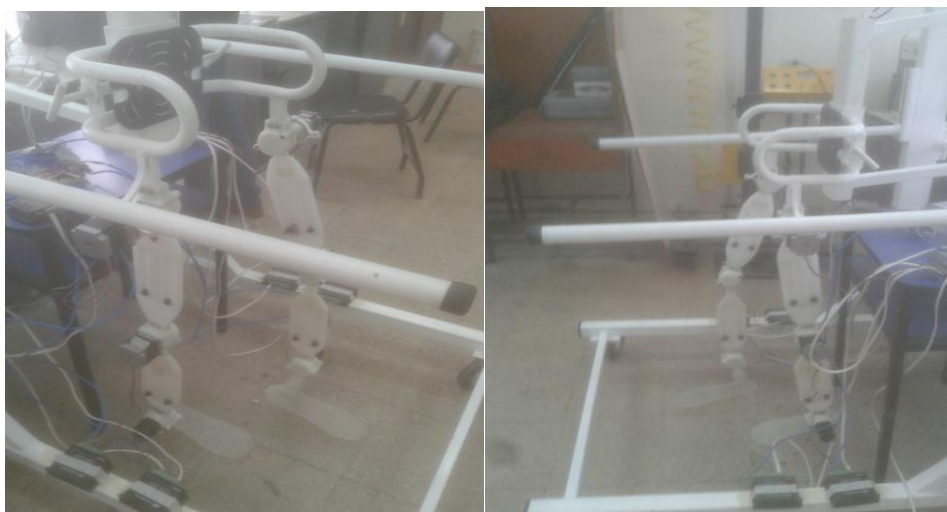
Figura 15-5 Sistema realizando el movimiento de la marcha humana Realizado por: Galo Maldonado
