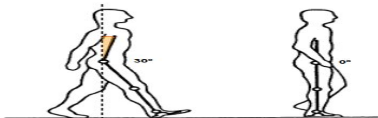
Figura 6-2. Estudio cinemático de la cadera en el intervalo I de la marcha. Fuente: Diseño y construcción de un prototipo neumático de prótesis de piernas, 2008
