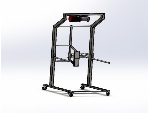
Figura 2-3. Prototipo del andador Realizado por: Galo Maldonado
