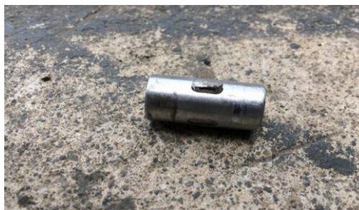
Figura 20-4. Acople de los motores tanto rodilla y tobillo. Fuente: Joel Lliguay, 2018
