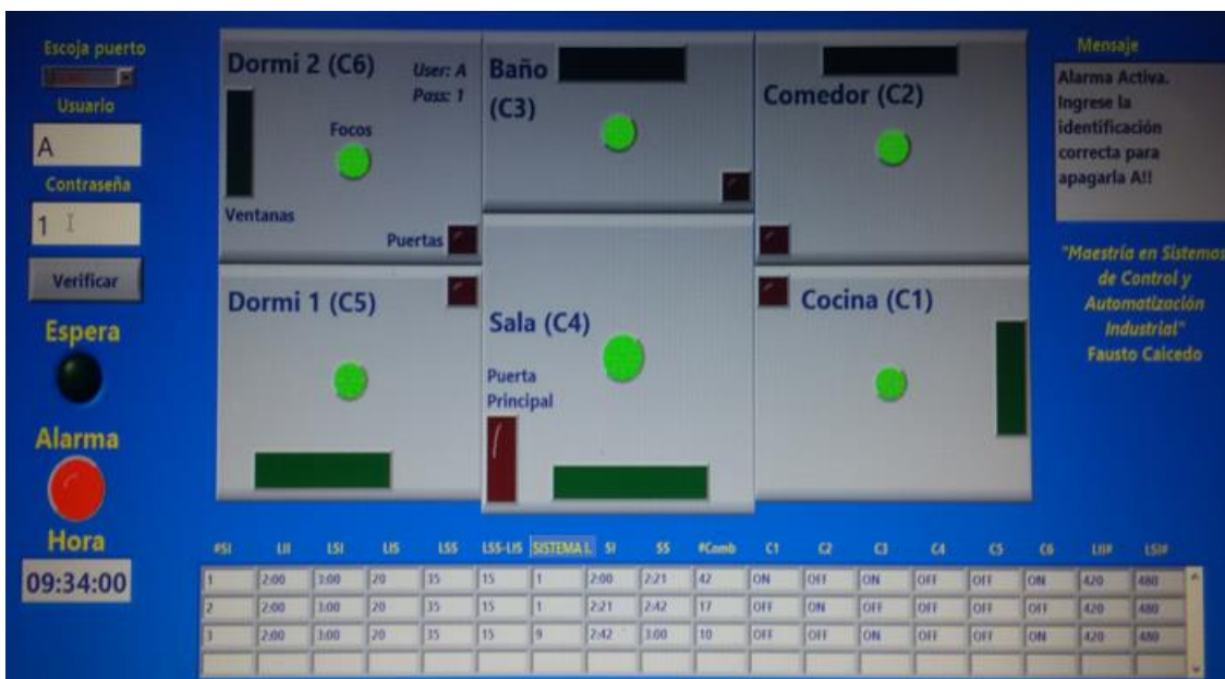
Figura 8-4: Encendido de alarma y luces. Realizado por: Caicedo Benavides Fausto 2018
