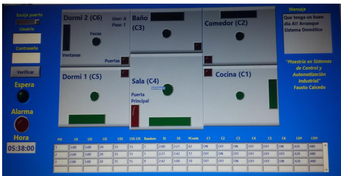
Figura 31-3: HMI del proyecto diseñado en LabVIEW. Realizado por: Caicedo Benavides Fausto 2018
