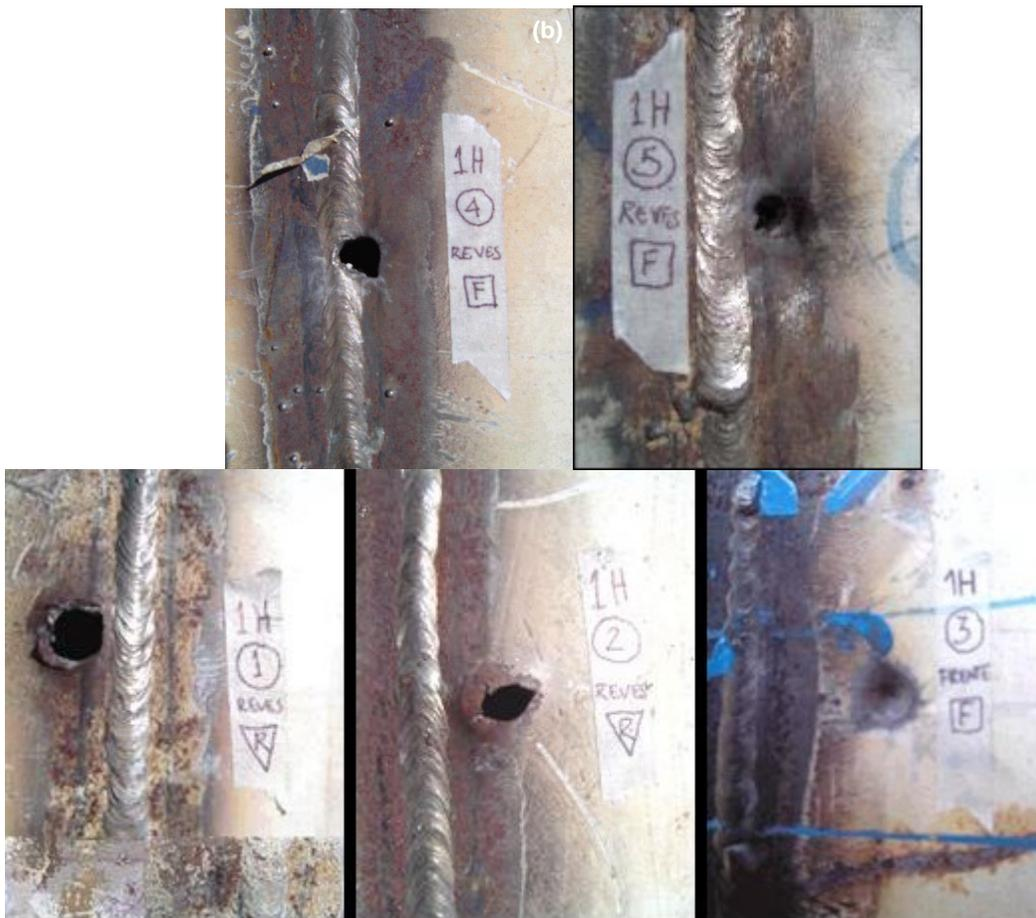
Figura 53. Impactos de proyectil en el cupón H de E680, todos pasantes con excepción del que golpeó el metal base no afectado térmicamente.
