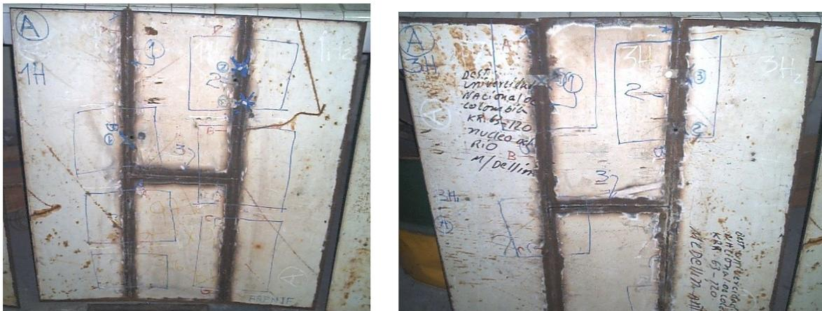
Figura 52. Placas H soldadas con electrodo E680 (izquierda) y E312 (derecha).
