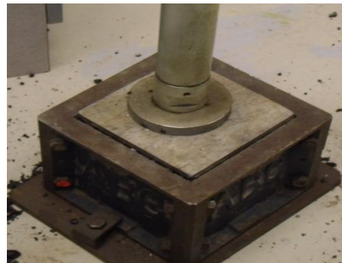
(d) Compact asphalt above HSC
