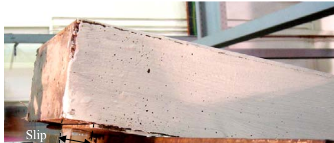
(d) Slip at beam end (Beam SLCS300) at the end of test
