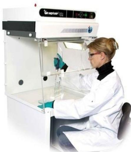
Figura 6) Câmara de Fluxo Laminar Vertical (Adaptado da referência 103)
