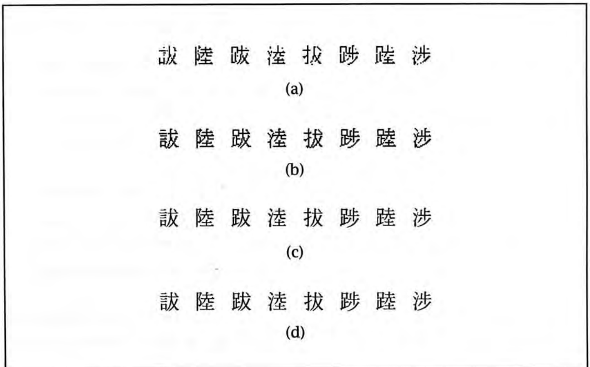
(a) Unhinted 20x20 bitmap. (b) Hinted 20x20 bitmap. (c) Unhinted 60x60 bitmap. (d) Hinted 60x60 bitmap.
