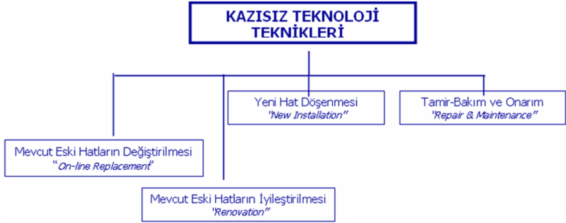
EK ŞEKİL 1. Kazısız rehabilitasyon teknikleri ile yapılan uygulamalar. (Yılmaz, 2009)
