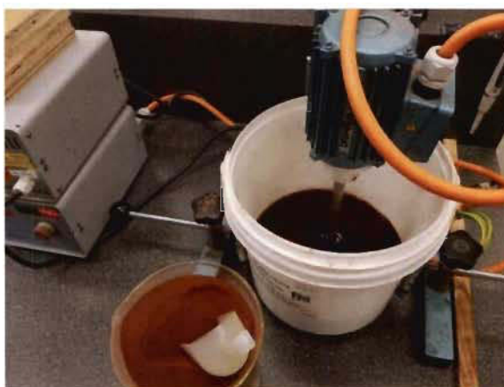
Figure 51 : Préparation de la formulation de la résine à base de tannins – hexamine
