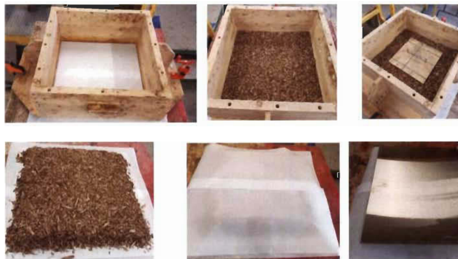
Figure 53 : Étapes de feutrage des ébauches
