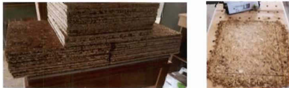
Figure 55 : Refroidissement et découpage des panneaux
