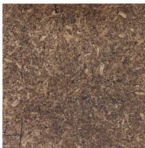
Figure 75 : Mauvaise répartition de la résine sur les panneaux encollés avec les tannins
