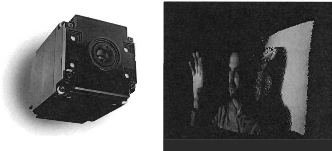
Figure 2.4 Caméra TOF et carte de profondeur par la caméra [ https://en.wikipedia.org/wiki/Time-of-flight_camera#/media/File:TOF_Kamera_3D_Gesicht.jpg ]
