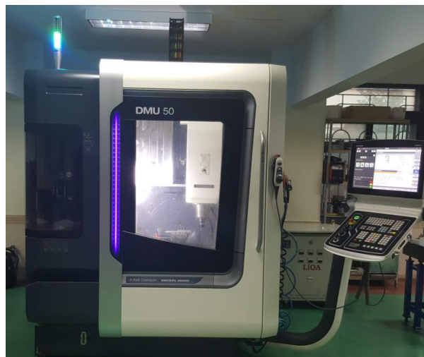
Fig. 2. 5-axis CNC machining centre DMG DMU50
