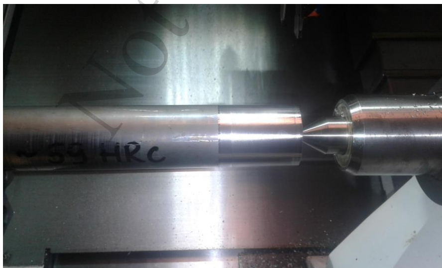
Рис. 15. Обробка загартованої сталі 13XB (HRC 57...60)
