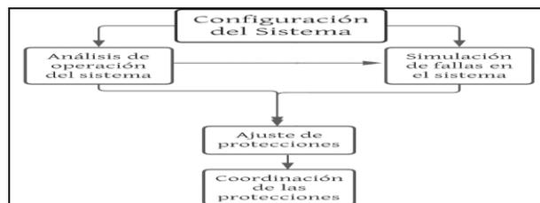
**Figura 11.** Pasos para la configuración del sistema.
