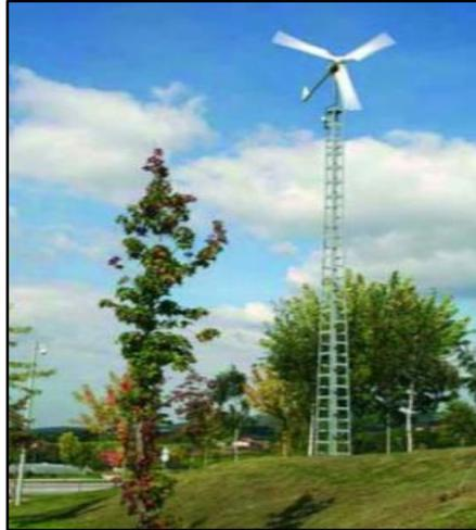
**Figura 7.** Aerogenerador de 6 kW.
