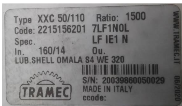
Figura 22: Targhetta Riduttore combinato e motore
