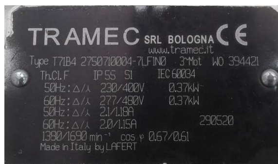
Figura 22: Targhetta Riduttore combinato e motore
