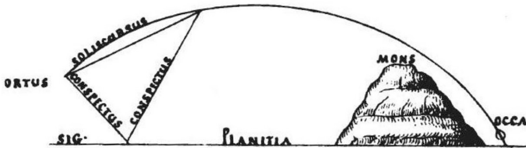
Fig. 4: Vignetta a commento del trattato di gromatica di Igino Minore inerente alla deformazione dell'asse del decumano derivata dalla presenza di rilievi naturali all'orizzonte (da G. LIBERTINI, Gli antichi agrimensori , Istituto di Studi Gli antichi agrimensori , Istituto di Studi Atellani, 2018, fig. 159 L.)
