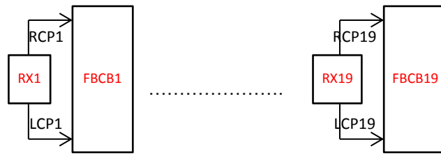
Fig. 1.2 I 19 ricevitori connessi ad altrettante schede del FCB
