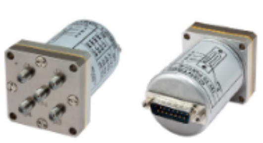
Fig. 8.3 Esempio di commutatore meccanico per la soluzione “a stella”
