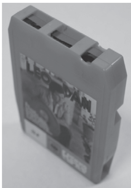
Imagen 5. Cartucho 8 Track. Funcionamiento de cinta magnética y cubierta de polietileno rígido.
