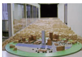
境界層風洞実験装置 Boundary layer wind tunnel
