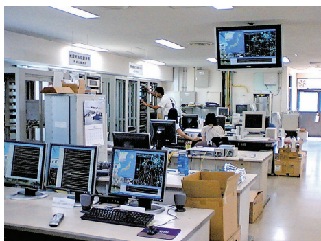
テレメーター装置室、ここに日本各地の地震観測記録や地殻変動連続観測記録 がオンライン・オフラインで集まる The telemeter room: Online and offline data from observation networks for earthquakes and crustal deformation are processed
