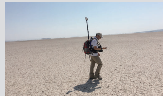
エチオピア・アフールのプレート拡大軸での磁気探査 Magnetic survey crossing the rift zone in Afar Depression, Ethiopia
