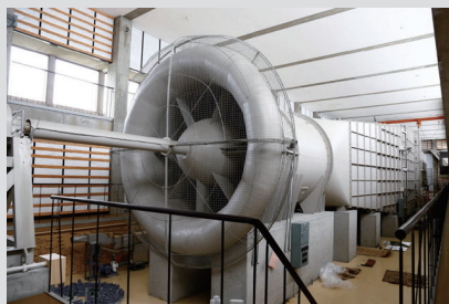
境界層風洞実験装置。建物に加わる風圧力や風環境に関する実験を行います Boundary layer wind tunnel : study on wind load on buildings and wind environment
