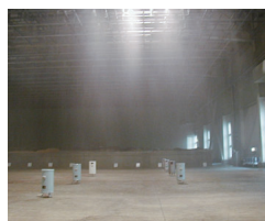
雨水流出実験装置
