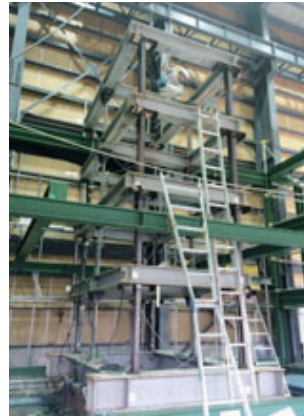
長周期構造物の振動実験における計測支援 Measurement support for the vibration test of a long period structure
