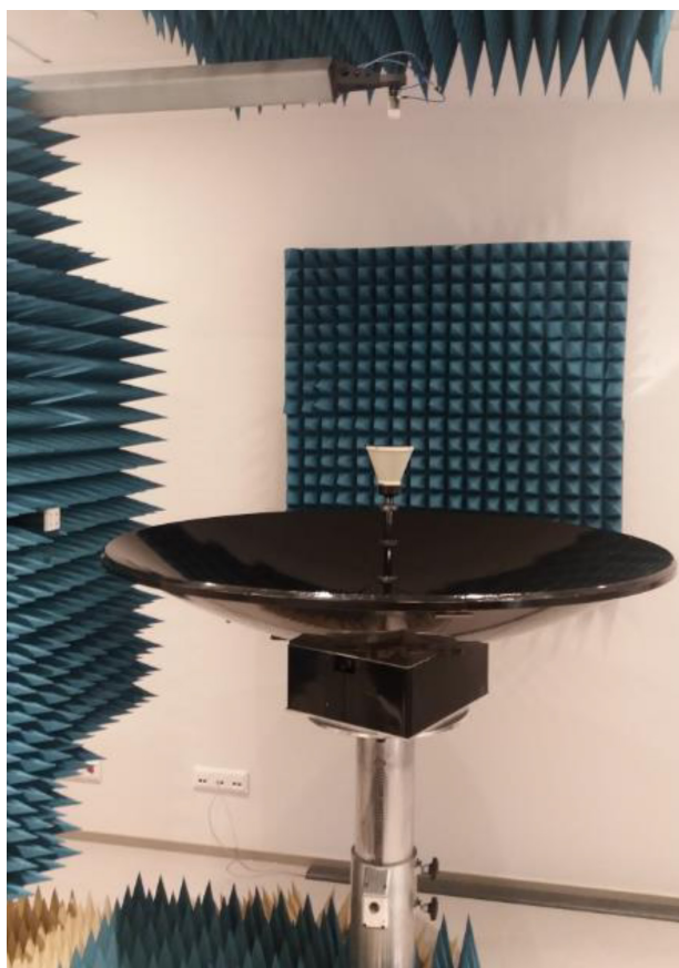
Рис. 4. Рабочее место стенда с установленной зеркальной антенной 08150.6220–0 с диаметром рефлектора 1,2 м
