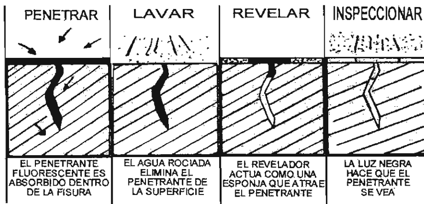
Figura 10.1. Principales pasos para el uso de los Líquidos Penetrantes
