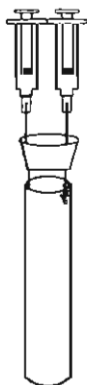
Figura 1.1 Tubo de ensayo, tapón de neopreno y jeringas desechables. Ensamble para la obtención de productos gaseosos, como en la reacción de metales con agua.
