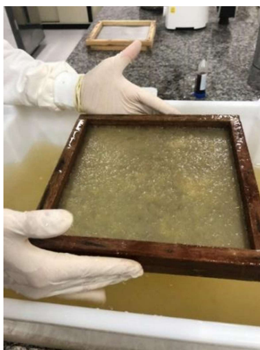
Figura 2: Pesca das partículas com a tela. FONTE: Acervo dos autores.
