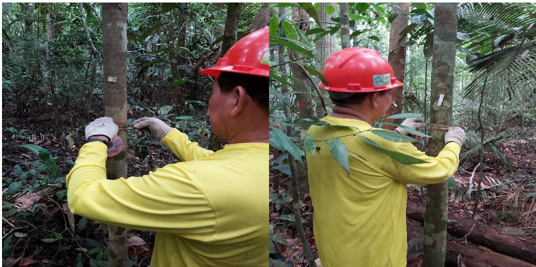
Figura 6. Medição do diâmetro utilizando a fita diamétrica para os indivíduos com 5 \text{ cm} \leq \text{DAP} < 15 \text{ cm} presentes nas UPAS B, C e D.
