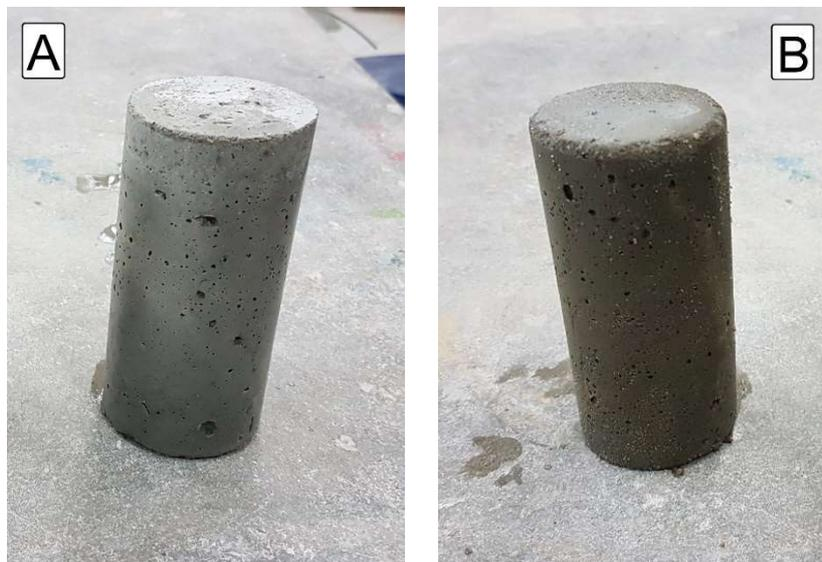
Figura 4. (A). Aspecto superficial da amostra com sílica ativa (SA) após 21 dias em solução de água e cal. (B) Aspecto superficial da amostra com sílica ativa (SA) após os 3 ciclos em solução ácida.
