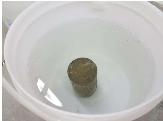
Figura 1. Corpo de prova de argamassa com sílica ativa (SA) em solução ácida
