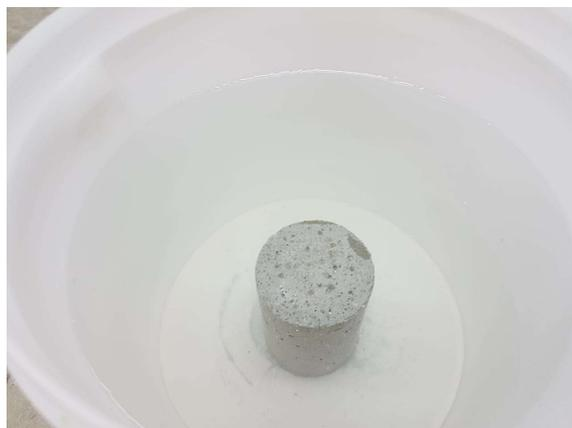
Figura 2. Corpo de prova de argamassa com sílica ativa (SA) em solução de água e cal
