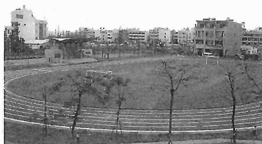
写真4 透水性舗装の陸上トラック トラックの中央は芝生
