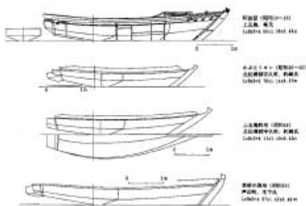
図3-8 各地釣船の船型(2) Various angling wasens (2).
