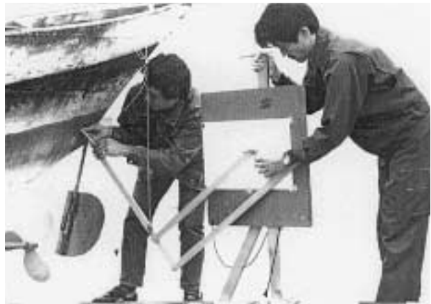
図 2 - 9 パンタグラフ使用による船型断面計測の例
