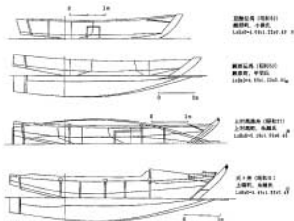
図3-9 各地釣船の船型(3) Various angling wasens (3).
