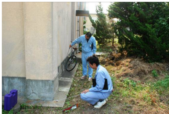
写真 5 回転打音検査法演習状況
