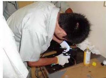
鋼構造物 の点検演習 (磁粉探傷試験)
