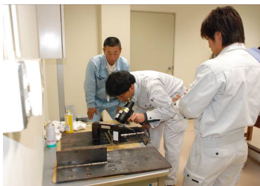
写真 3 磁粉探傷試験演習状況
