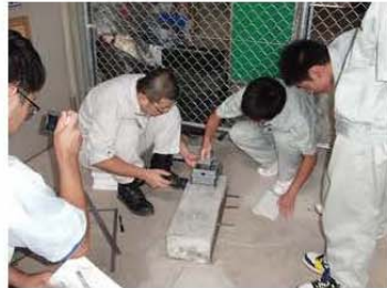
コンクリート構造物 の点検演習 (電磁波レーダー法)
