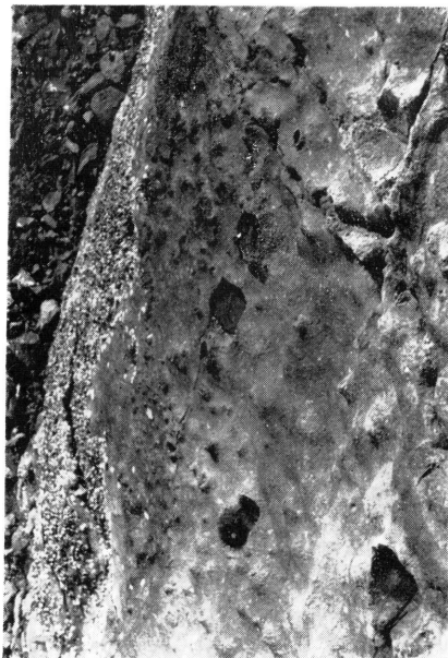
6. 左図の露頭の接写。(ほぼ実大) 白色斑点が加里長石・石英など、暗色部は主に岩片である。
