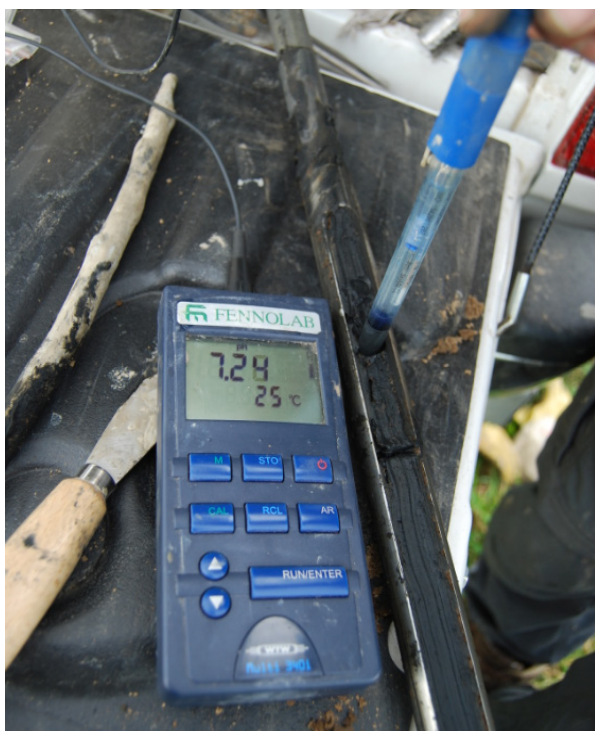
Kuva 12. Maanäytteen pH:n mittaaminen suoraan näytteen pinnalta.
