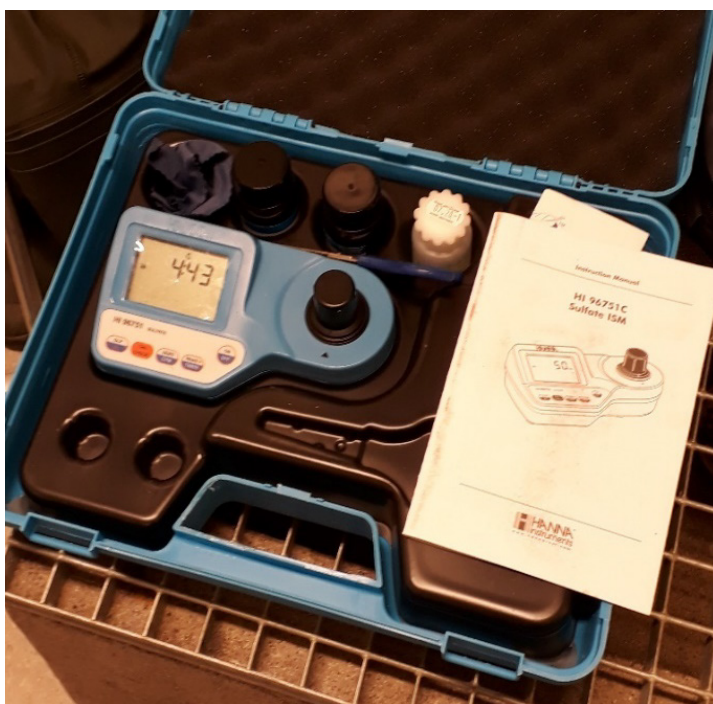
Kuva 17. Hanna Instrumentin maastokäyttöinen sulfaattianalysointilaitteisto.
