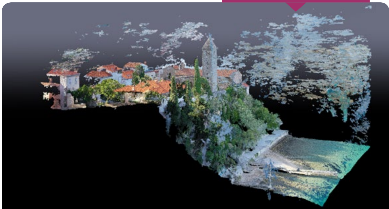
SLIKA 9. 3D MODEL S ODREĐENIM POSTOTKOM ŠUMA (KAŠTELAN 2020).
