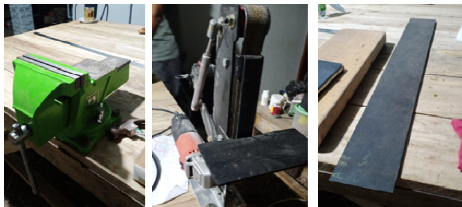
Gambar 1 Ragum, pengasah dan Baja ASAP yang digunakan pengrajin untuk membuat pisau dapur
