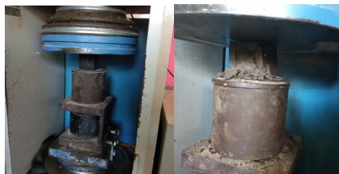
Gambar 6. Pengujian Kuat Tekan Mortar Geopolimer
