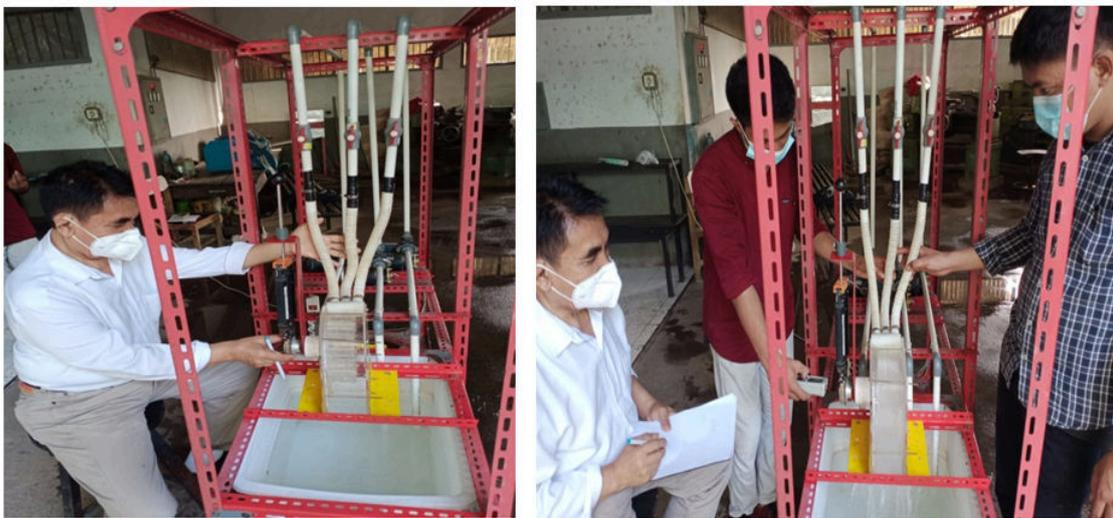
Gambar 1 Instalasi Pengujian Turbin Cross Flow 3 (tiga) Nossel
