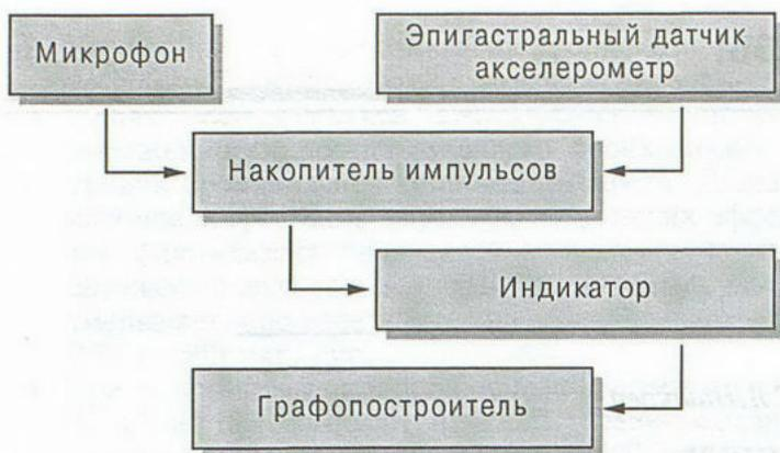
Рис. Схема устройства туссометра.
