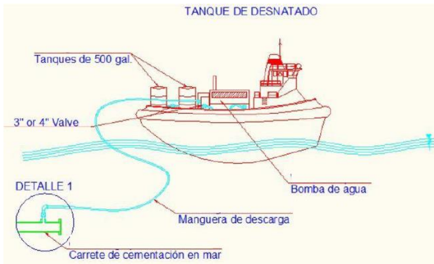
Figura 4. Procedimiento de cementación en la zona off-shore imagen referencial
