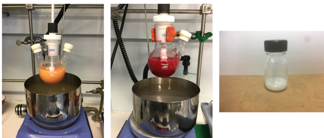
Figure 6.6. Images illustrant le milieu réactionnel en fin de réaction de polymérisation de (à gauche), PSS@MG-RB[14 % ; 0,14 %], (au centre) de PSS@MG-RB[14 % ; 0,70 %] et (à droite) une solution aqueuse contenant un polymère synthétisé à partir du système {ADV + AcV + CLV} selon la méthode montrée à la Figure 6.4.
