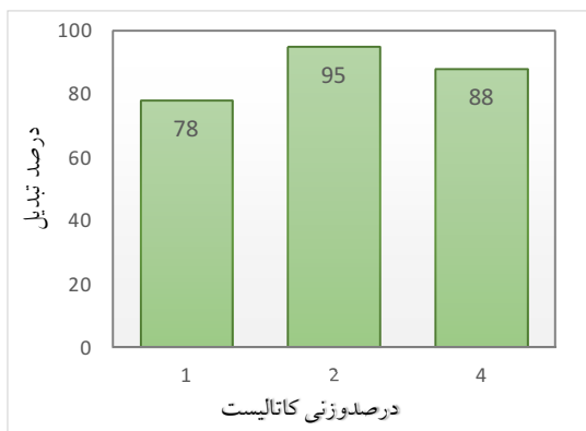
شکل ۲- تاثیر درصد وزنی کاتالیست بر راندمان بیودیزل Figure 2- Effect of weight percent of catalyst on biodiesel efficiency
