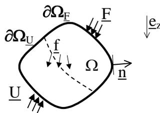
**Figure 1** Définition du chargement mécanique
