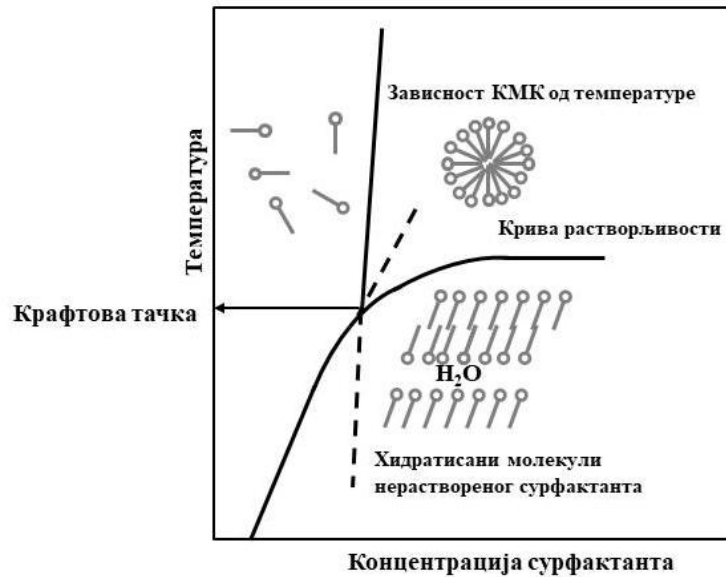
Слика 4. Шематски приказ температурне зависности растворљивости јонског сурфактанта; КМК – критична мицеларна концентрација, T_K – Крафтова тачка (температура на којој је растворљивост сурфактанта једнака КМК) (прилагођено из референце [87]; одобрено за коришћење у докторској дисертацији дозволом издавача Elsevier )
