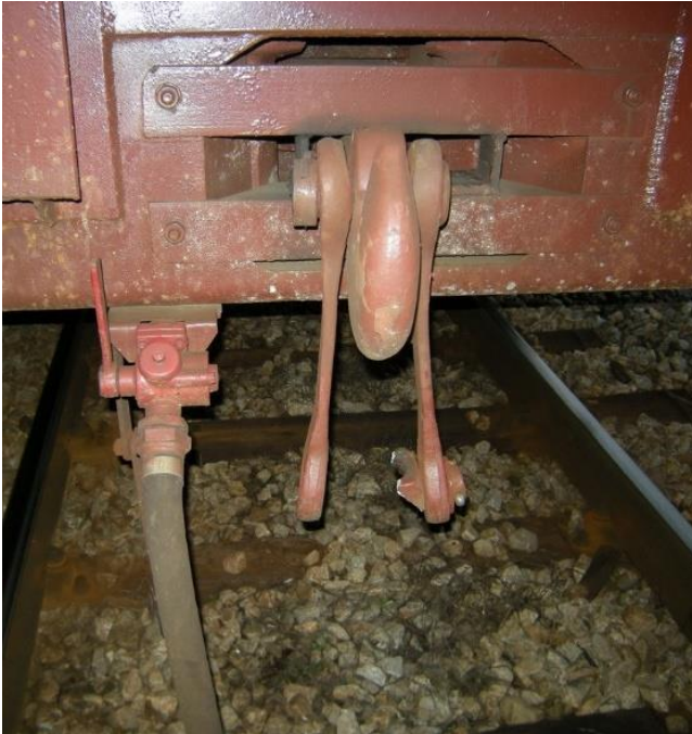
Slika 3.39. Lom navrtke uz vešalicu pri raskinuću 08.07.2011. kod Užica na vagonu broj 21782900038-9 (Republika Hrvatska) [35]
