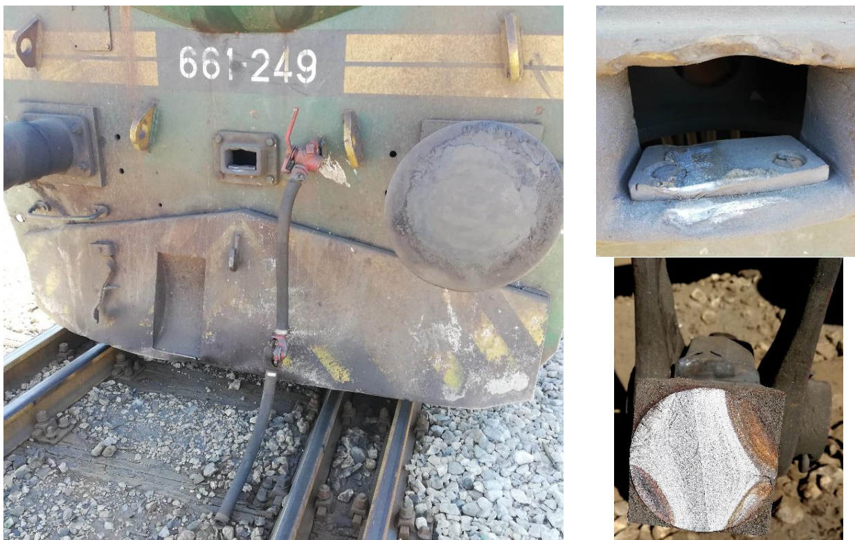
Slika 3.37. Lom kuke tegljenika pri raskinuću 6.9.2020. kod stanice Bor teretna na lokomotivi 661-249 (RS) [36]
