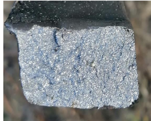
Slika 3.39. Lom navrtke uz vešalicu pri raskinuću 08.07.2011. kod Užica na vagonu broj 21782900038-9 (Republika Hrvatska) [35]
