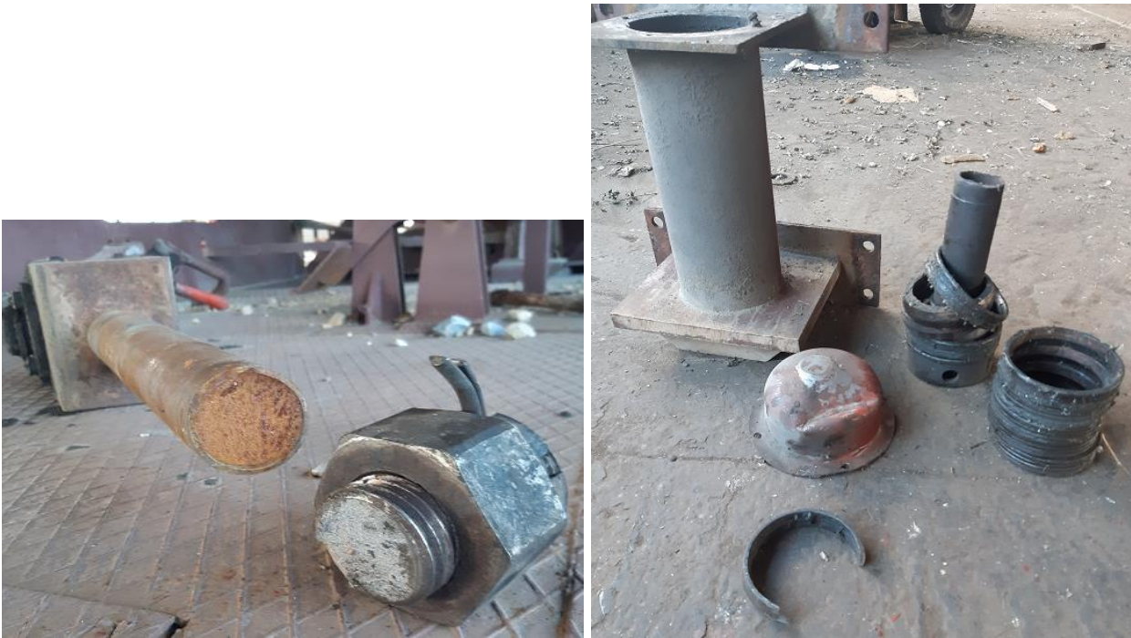
Slika 3.33. Lom tegljenice i prstenaste opruge tegljenika [73]
