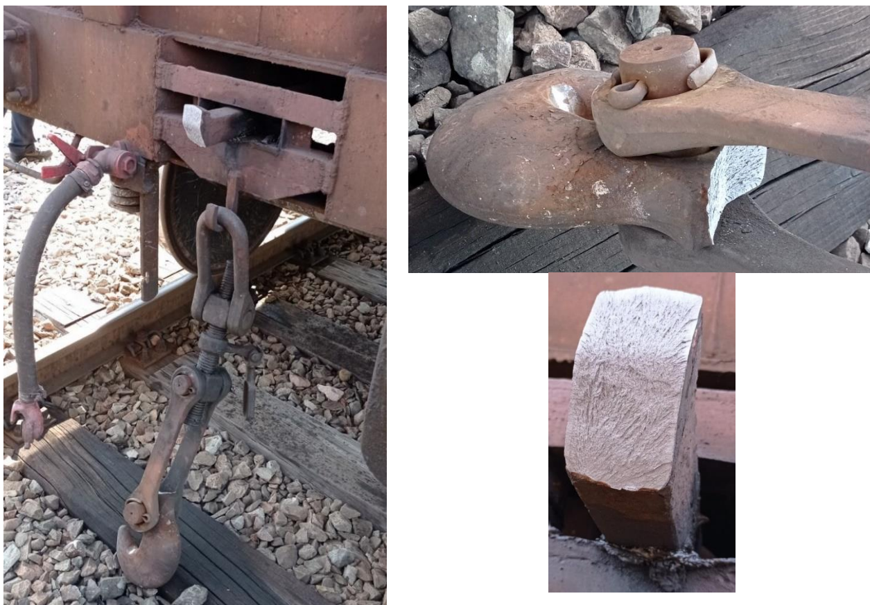
Slika 3.38. Lom kuke tegljenika pri raskinuću 04.03.2021. kod Ovče na vagonu broj 33874769158-6 (Francuska)
