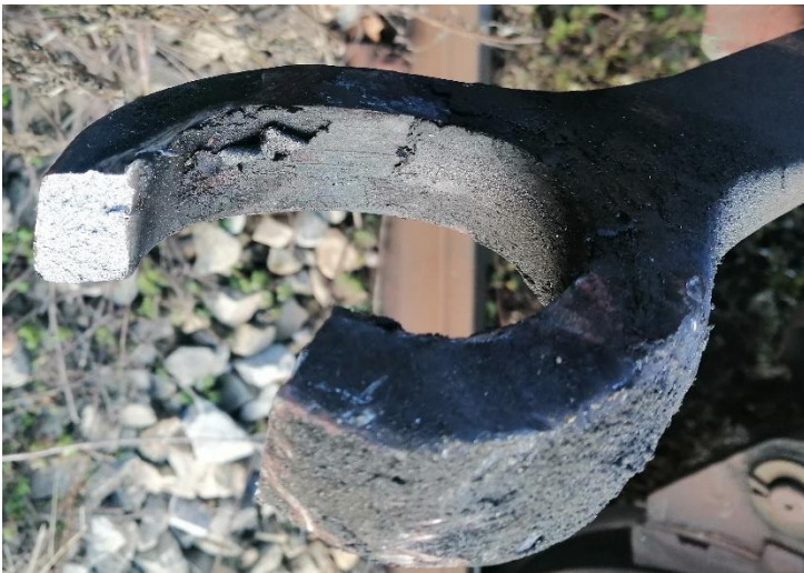
Slika 3.40. Lom vešalice pri raskinuću 17.12.2020. kod Paraćina, vagon Eas-z broj 31655980050-3 (Republika Makedonija) [36]
