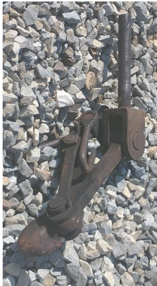
Slika 3.34. Lom viljuškaste tegljenice, pri raskinuću 21.8.2020. kod Velike Plane na Eas vagonu broj 31505970018-9 (Bosna i Hercegovina) [36]
