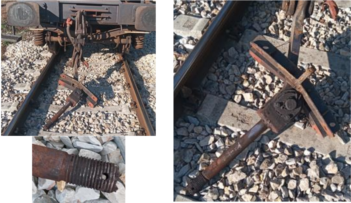
Slika 3.35. Izvlačenje viljuškaste tegljenice, pri raskinuću 23.10.2020 kod Rakovice na Zaes-z vagonu broj 82726596048-0 (RS) [36]
