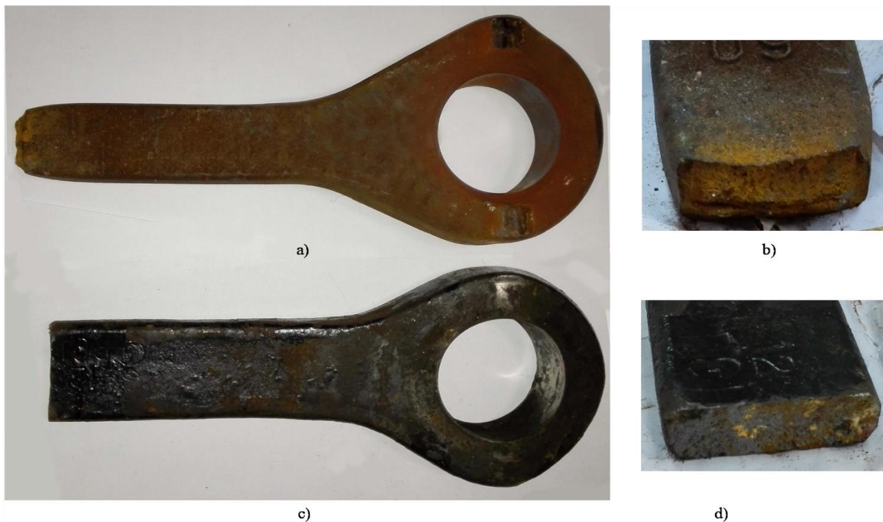
Slika 5.1 Lom vešalice, a) duktilan lom (uzorak 1), b) detalj duktilnog loma, c) krti lom (uzorak 2), d) detalj krtog loma
