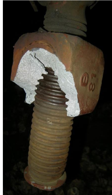
Slika 3.39. Lom navrtke uz vešalicu pri raskinuću 08.07.2011. kod Užica na vagonu broj 21782900038-9 (Republika Hrvatska) [35]
