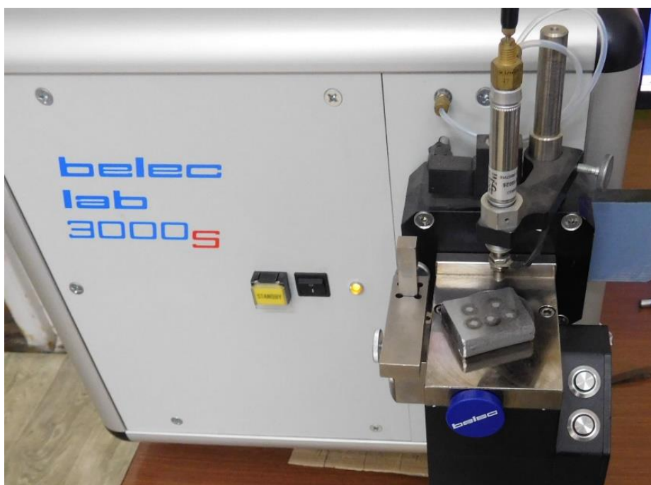
Slika 6.8. Ispitivanje hemijskog sastava vešalice na spektrometru Belec Lab 3000s
