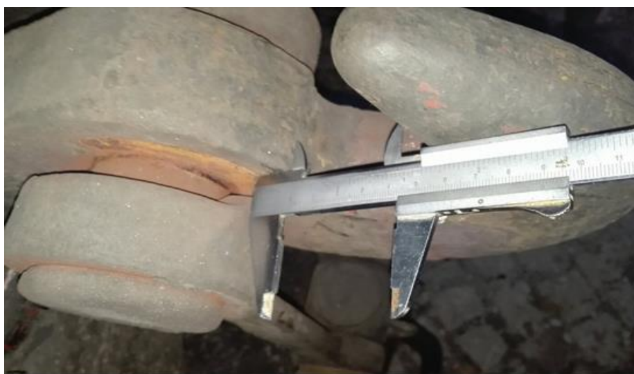
Slika 7.13. Merenje otvorenosti kuke tegljenika kljunastim pomičnim merilom
