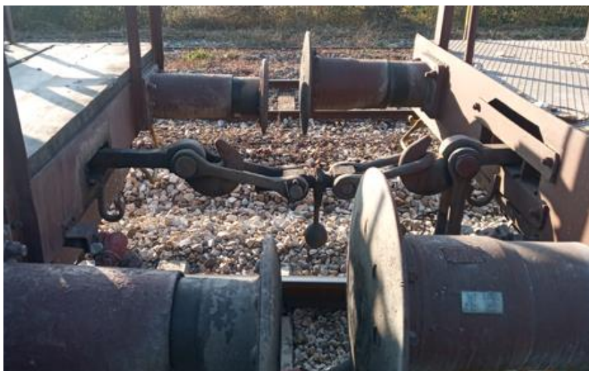
Slika 7.4. Razmak između odbojnika teretnih kola u kompoziciji koja treba da su lako pritegnuti (raskinuće 06.11.2020. voza 53412, Debeljača)
