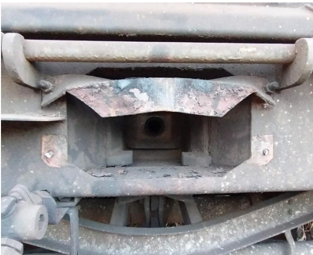
Slika 3.33. Lom tegljenice i prstenaste opruge tegljenika [73]
