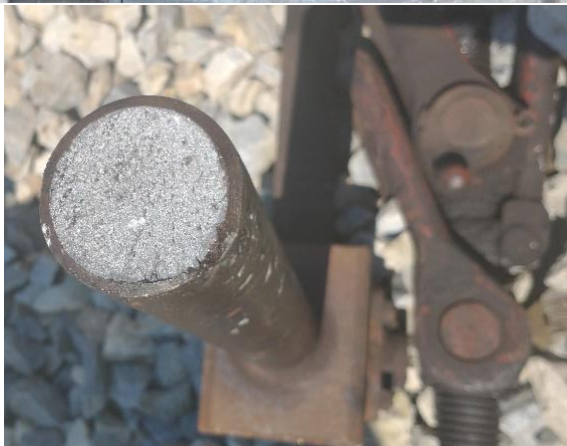
Slika 3.34. Lom viljuškaste tegljenice, pri raskinuću 21.8.2020. kod Velike Plane na Eas vagonu broj 31505970018-9 (Bosna i Hercegovina) [36]
