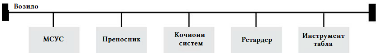
Слика 3.2: Типична диспозиција J1939 мреже [61]
