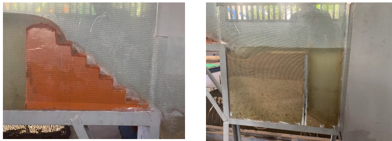
Gambar 5. Gerusan lokal pada kondisi ketinggian air di hulu 2 cm
