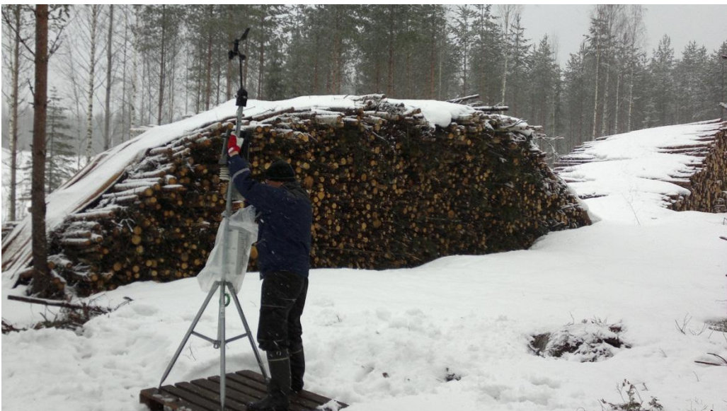
Kuva 2. VTT:n sääasema, jolla mitattiin varastokasan ympäristön sääolosuhteet.
