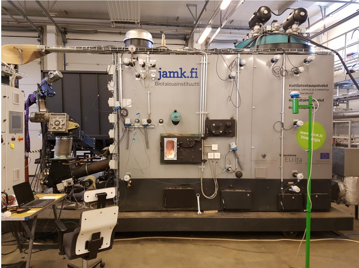
Kuva 1. Biotalousinstituutin kattilatestauslaboratorion 500 kW haketestauskattila.
