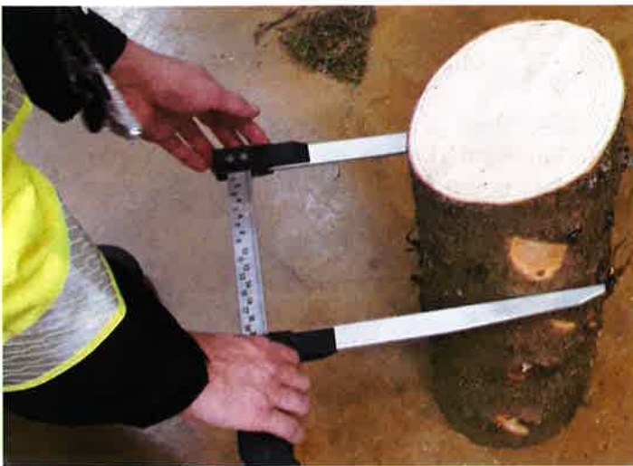
Kuva 19. Vertailuarvo läpimitalle määritettiin mittasaksilla noin puolivälistä pölkkyä.
